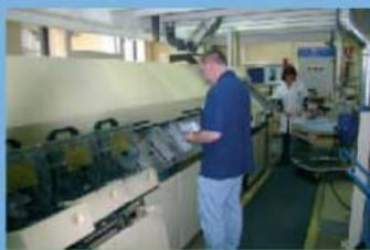
Des machines de tri contrôlent chaque billet au rythme de 40 à la seconde et détruisent les exemplaires imparfaits.
