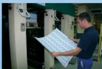
Machine d'impression offset recto-verso : les motifs du verso des billets et une grande partie de ceux du recto sont imprimés simultanément.
