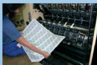
Machine à numéroter : chaque billet possède son propre numéro. Les numéroteurs mécaniques sont tous reliés à un ordinateur de contrôle.
