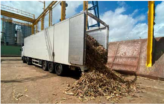
Martinique. Remorque avec benne utilisée pour le transport de canne tronçonnée des champs vers la sucrerie du Galion ou vers les distilleries de l'île. Déchargement de la remorque dans la cour de réception des cannes à la sucrerie du Galion. Ces cannes tronçonnées ont été coupées à la machine. © Olivier Grolleau, Centre technique de la canne et du sucre de Martinique
